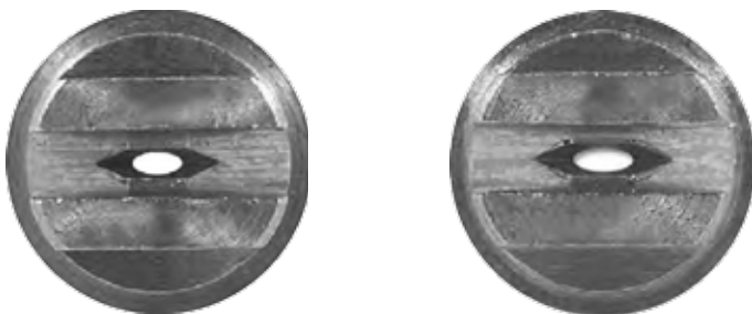
Boquillas con desgaste de un 30% (a la derecha) no muestran cambios visibles.
